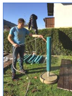
Reinigung der Filterstrümpfe
