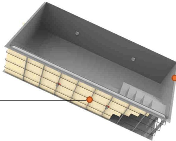
Verstärkung der oberen Poolkante aus Paneltim® bei der Skimmer- Variante
